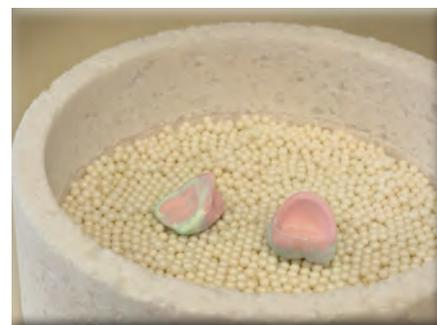
Lavorazione completamente asciutta prima della sinterizzazione con il forno YETI SINT
