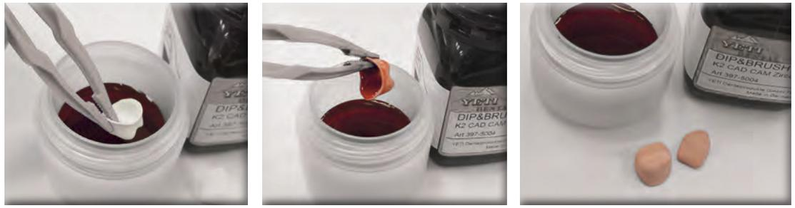
Immergere la parte di restauro fresata in zirconio con una pinzetta di plastica nel liquido per zirconio K2.
