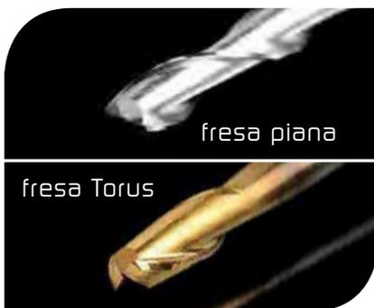
Le frese piane a doppia taglio, con un diametro di taglio piatto di 1,2 mm, sono usate per la fresatura a 90°, dato il loro impiego nella perforazione e nel abutment (spalla). Per il trattamento di materiali a base di Cr/Co, questi strumenti, come i cutter torus, sono equipaggiati di un lieve angolo radiale, in modo da trattare i bordi di taglio con premura, garantendo una prolungata longevità d'utilizzo.
