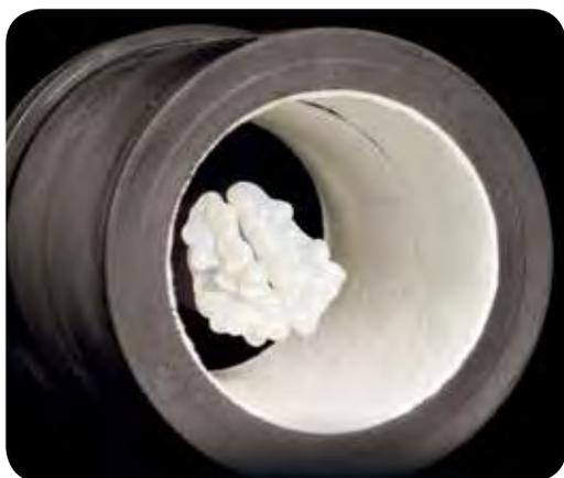
La fibra per cilindri bianca inserita all'interno del cilindro scuro crea una migliore definizione visiva della modellazione durante la messa in rivestimento.
