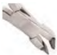
P1914-00 Micro tronchesino distale Manici lunghi, con trattenuta del filo. Massima capacità di taglio: -filo rettangolare .022" x .028" (0,56 x 0,71 mm) -filo tondo .020" (0,51 mm) -filo twist .016" (0,41 mm) cod 00029326 € 171,30
