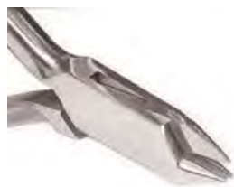
P1075-01 Pinza di Aderer a 3 punte fini Per fili tondi fino a .020" (0,51 mm) e rettangolari fino a .021" (0,53 x 0,64 mm). cod 00027970 € 163,10
