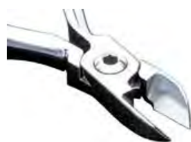
P2109-00 Tronchese per fili duri Massima capacità di taglio: fili tondi .020" (0,51 mm) e rettangolari .022" x .028" (0,56x0,71 mm). cod 00088338 € 103,80
